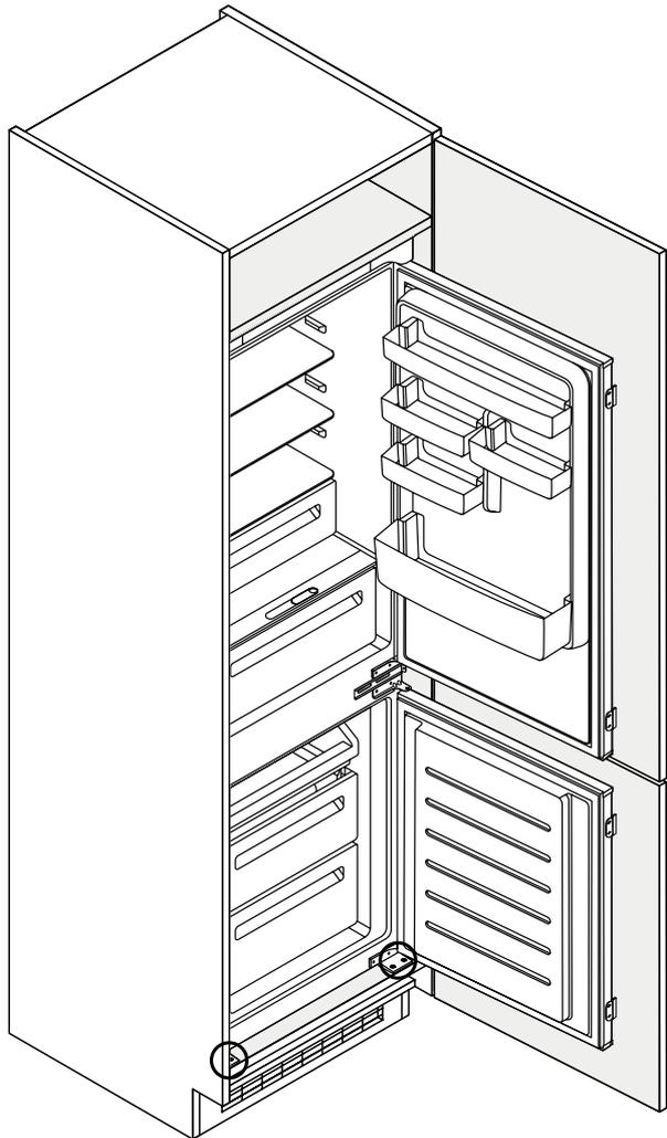
Utilizzando le viti in dotazione, fissare i piedini al ripiano inferiore.
