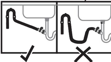
Vérifiez que le tuyau de vidange est branché en ligne droite jusqu'au raccord. Sectionnez la partie de tuyau de vidange en excès, si nécessaire. Ne
