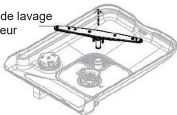
Pour retirer le bras de lavage inférieur, soulevez-le de la base du lave-vaisselle. Rincez abondamment le bras de lavage sous l'eau courante, puis remettez-le en place. Vérifiez que le bras tourne librement lorsqu'il est réinstallé.
