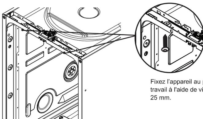
Fixez l'appareil au plan de travail à l'aide de vis  $\text{Ø}4$  x 25 mm.
