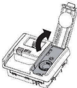
Soulevez le couvercle et versez du liquide de rinçage dans l'ouverture.
