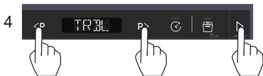
Appuyez sur <P ou P> pour régler le niveau. Appuyez sur pour enregistrer les paramètres. RESET 3\*
