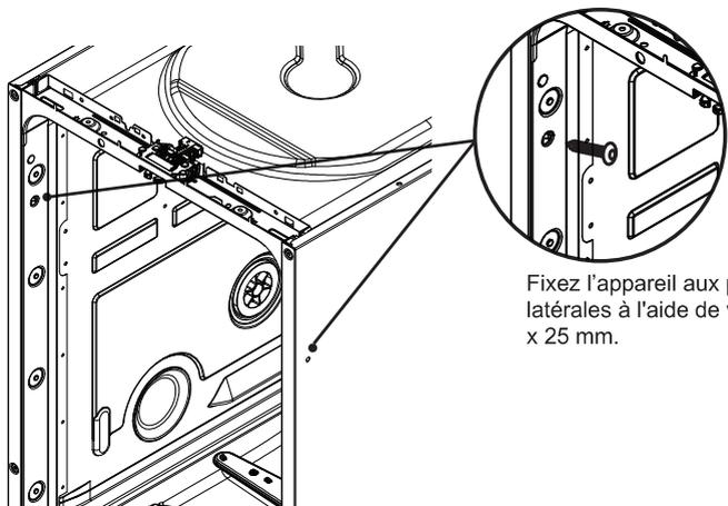
Fixez l'appareil aux parois latérales à l'aide de vis  $\text{Ø}4$  x 25 mm.
