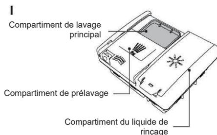
Vérifiez que le distributeur est vide et sec. Ajoutez du détergent ou des tablettes dans le distributeur de détergent.
