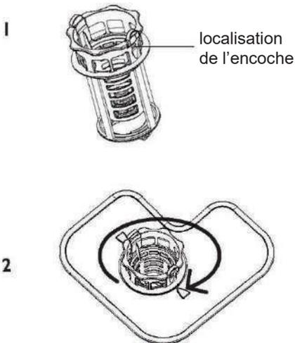
Alignez le bouchon du filtre sur l'encoche sur la base du filtre. Vérifiez que la structure de la boucle est en place.
