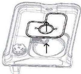
Retirez le filtre de vidange et la plaque filtrante. Utilisez une éponge pour retirer le reste d'eau en dessous avant de les remettre en place.
