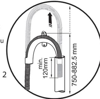
L'installateur doit fournir un raccord de tuyau de vidange approprié pour un T à déchets de 15 mm min.
