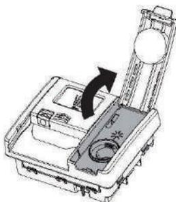
Si le voyant du liquide de rinçage s'allume, remplissez le distributeur de liquide de rinçage. Reportez-vous à la section « Liquide de rinçage » pour obtenir des conseils supplémentaires.
