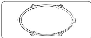
**01 Anneau de guidage**, à placer au centre du four. L'anneau de guidage sert de support au plateau.
