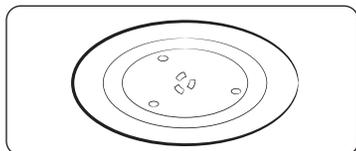
**02 Plateau tournant**, à placer sur l'anneau de guidage en enclenchant la partie centrale sur le coupleur. Ce plateau constitue la principale surface de cuisson ; il peut être facilement retiré pour être nettoyé.
